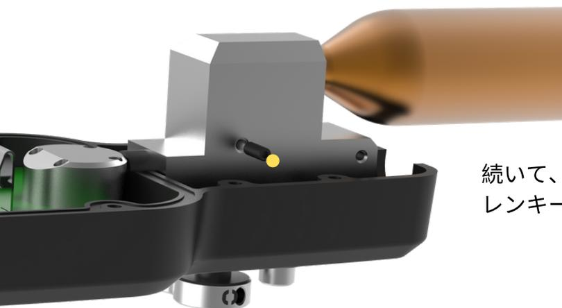
続いて、金属部の側面にあるM3x8ネジを1.5mmアレンキーで外します(左側の画像に黄色の点)
