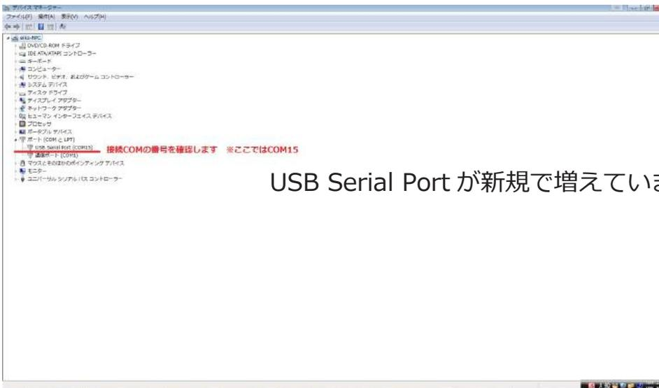
USB Serial Port が新規で増えていますので、その COM 番号を確認します
