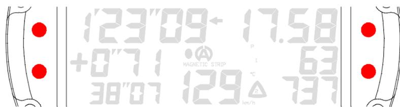
本体が START mode の場合、自動的に STOP mode に切り替わり電池残量が少なくなって10分後には操作がロックされ、「**CHANGE BAT**」メッセージがディスプレイに表示されます。この時点で« **Config System** »への移行も不可能となってしまうので、すぐに電池交換を行うことをお勧め致します。
